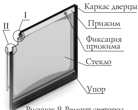
Рисунок 9. Ремонт светопрозрачного экрана двери модели «Витра»
